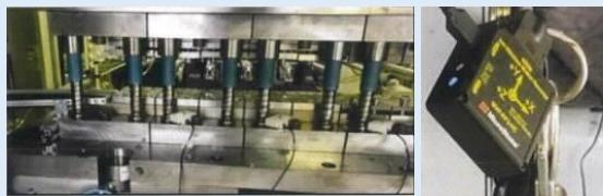
また、センサーから得られた振動データをもとにAIソフトにより標準振動データを自動生成して、標準値との比較により異常を検知し、表示灯（パトライト）からアラートを発出することで、ショット異常を速やかに認識することができるようになった。
